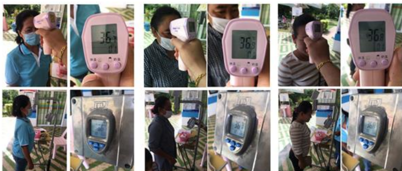
เปรียบเทียบเครื่องวัดอุณหภูมิ อินฟราเรด สวิทซ์เท้า กับเครื่องวัดอุณหภูมิอินฟราเรดแบบเดิม
